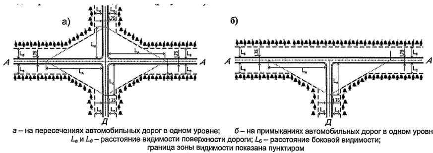
**Рисунок 6.2 – Схемы обеспечения видимости**
